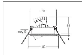
Einbaustrahler, weiß, rund. Ausgeführt in kompakter Bauform für werkzeuglose Schnellmontage zum Deckeneinbau. Fassung: GX5,3, Montageart: Einbaumontage, Montageort: Deckenmontage, Material: Aluminium, Schutzart: nach DIN EN 60529: IP20, Schutzklasse: (EN 61140) III, Spannung: 12V, Leistung: max. 50W, Anzahl der Leuchtmittel / Fassungen: 1.0 Stk, Verstellbarkeit: schwenkbar, ohne Betriebsgerät, Art der Dimmung: sonstige, .
