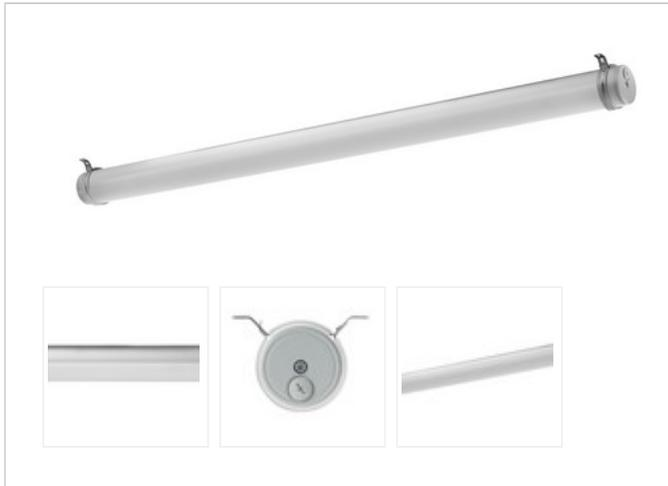
Rundrohrleuchte für T8 LL, Durchmesser 90mm, Rundrohrgehäuse aus PRACHTOPAL (PMMA, schlagzäh), EVG in Leuchte integriert, Leuchte 360° drehbar, weitestgehend säure- und laugenbeständig, kurze, alterungsbeständige Dichtungen aus Silikon, variable Befestigungsabstände durch PRACHT-Edelstahl-Schellen, geeignet für Decken-, Tragschienen- und senkrechte Wandmontage, Pendel- und waagerechte Wandmontage mit Zubehör möglich, auch für den ungeschützten Außenbereich zugelassen
