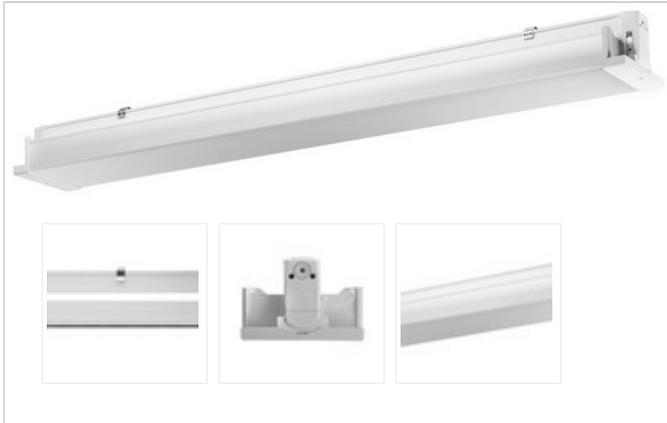
LED Leuchte zum bündigen Einbau. Mit Abdeckung aus PRACHTOPAL (PO) und Leuchtengehäuse aus GFK-Polyester, weiss. Mit MID-Power LEDs, Konverter in Leuchte integriert, mit kurzen, alterungsbeständige Silikondichtungen, geeignet für die Decken- und waagerechte Einbaumontage. IK06. Achtung: PRACHT MANUFAKTUR! Sie benötigen eine andere Lichtfarbe, Gehäusefarbe oder Durchgangsverdrahtung? Besondere Herausforderungen? Kein Problem. Wir bieten individuelle Lösungen für Ihre Anforderungen.
