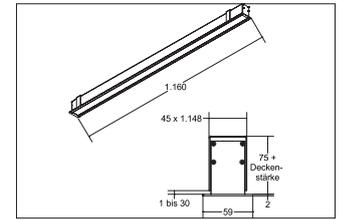
LED-Einbauprofil BIRO40, silber, rechteckig. LED-Lichtkanal mit satiniertes Abdeckung. Ausführung: LED, Montageart: Einbaumontage, Montageort: Deckenmontage, Material: Aluminium / Acryl, Schutzart: nach DIN EN 60529: IP20, Schutzklasse: (EN 61140) I, Spannung: 230V AC 50Hz, Leistung: 31,4W, Lichtstrom: 2.740lm, Farbtemperatur: 4000K, Lichtfarbe: weiß, Abstrahlwinkel: 80°, Verstellbarkeit: nicht verstellbar, mit Betriebsgerät.
