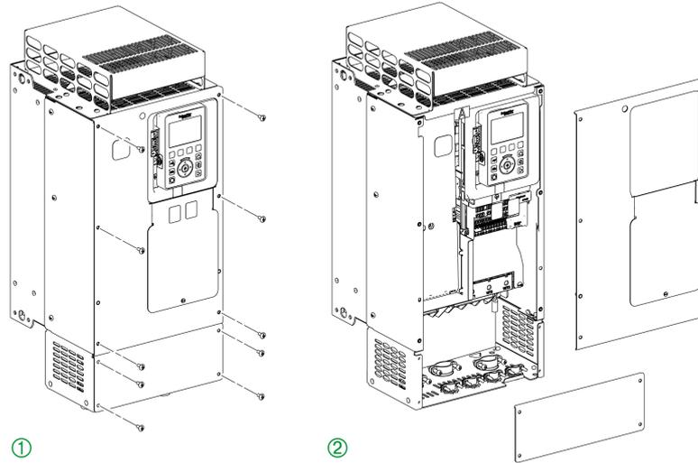
按照下列说明连接机架尺寸为 3S 和 5S 的变频器上的端子
