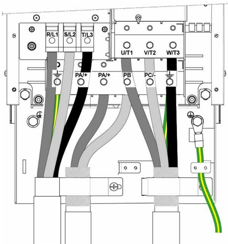
PA/+ 和 PB 端子用于连接制动电阻器。请参考制动电阻器说明书 NHA87388，可从 [www.se.com](http://www.se.com) 上获取。
