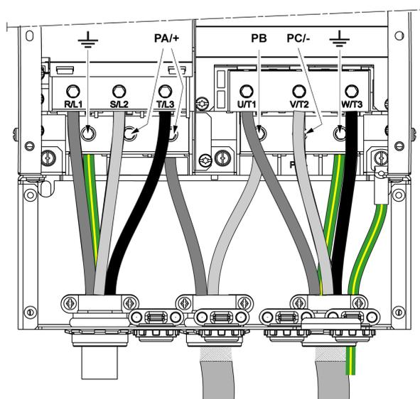
PA/+ 和 PB 端子用于连接制动电阻器。请参考制动电阻器说明书 NHA87388，可从 [www.se.com](http://www.se.com) 上获取。
