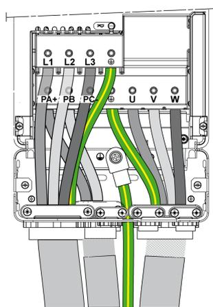
PA+ 和 PB 端子用于连接制动电阻器。请参考制动电阻器说明书 NHA87388，可从 [www.se.com](http://www.se.com) 上获取。
