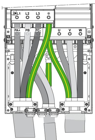
PA/+ 和 PB 端子用于连接制动电阻器。请参考制动电阻器说明书 NHA87388，可从 [www.se.com](http://www.se.com) 上获取。
