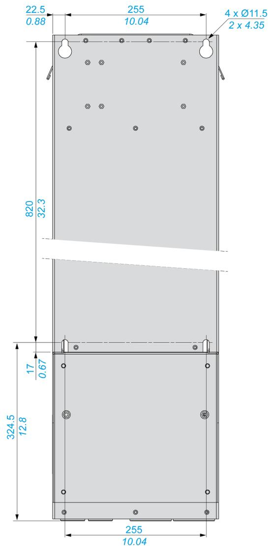
**注:** 下方导线接线盒 VW3A9704 单独销售。此零件可将产品安装在墙上。它可保持底部达到 IP21 防护等级和 UL 类型 1 防护等级。
