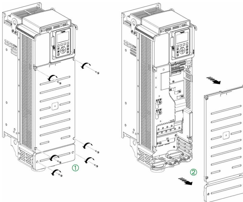
遵循以下操作说明以找到机架尺寸为 4 和 5 的变频器上的端子
