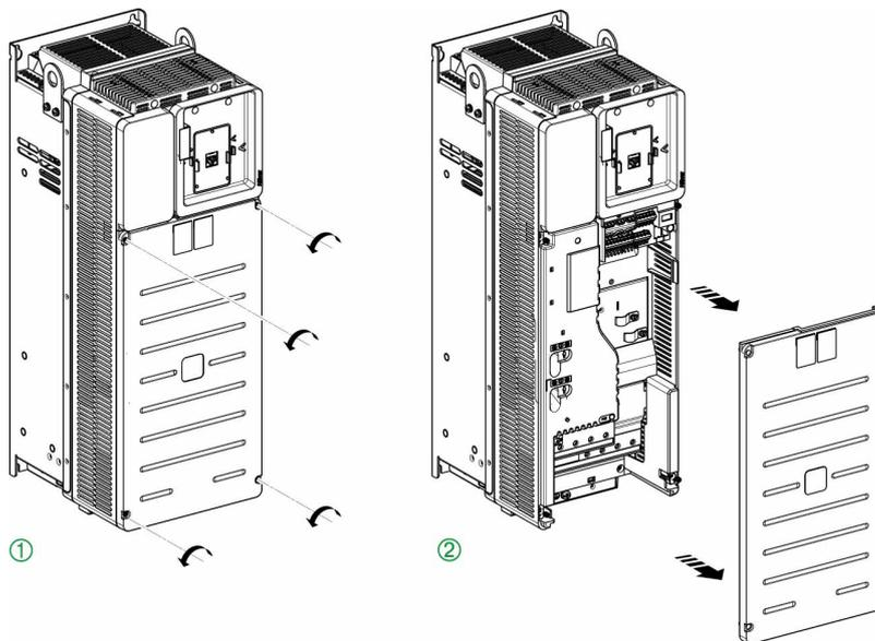
遵循以下操作说明以找到**机架尺寸为 4 和 5**的变频器上的端子
