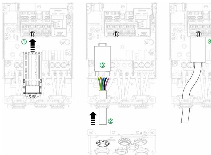
**注:** 图中所示的接线板适用于机架尺寸 2。其他接线板与此接线板稍有不同。
