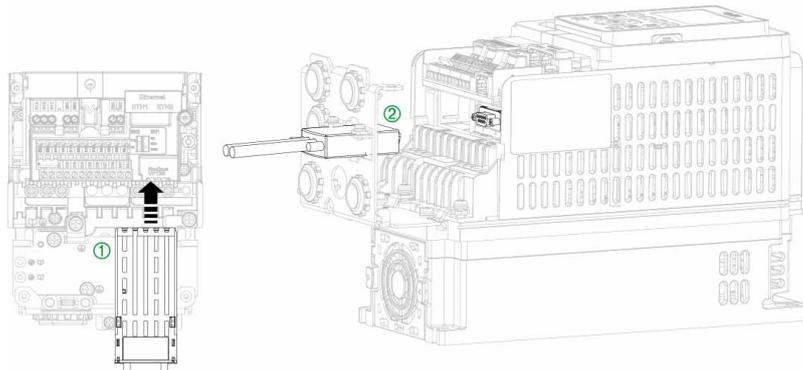
为帮助确保对控制部分正确接线，请遵循以下操作说明来在机架尺寸为 1 的变频器上安装 PROFIBUS 现场总线模块。
