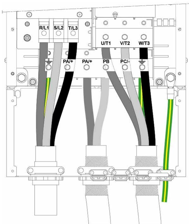
PA+ 和 PB 端子用于连接制动电阻器。请参考制动电阻器说明书 NHA87388，可从 [www.se.com](http://www.se.com) 上获取。
