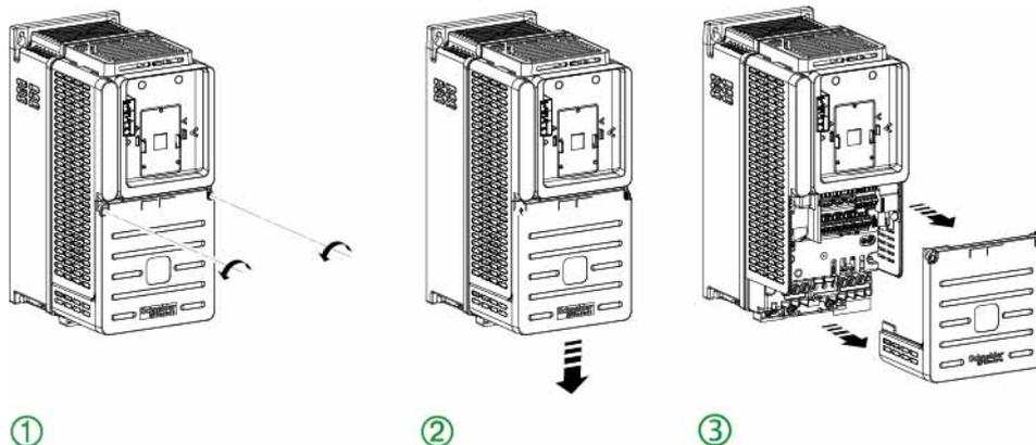
按照下列说明连接机架尺寸为 1 到 3 的 IP20 型变频器上的端子
