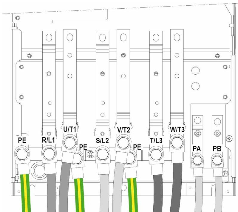
PA+ 和 PB 端子用于连接制动电阻器。请参考制动电阻器说明书 NHA87388，可从 [www.se.com](http://www.se.com) 上获取。
