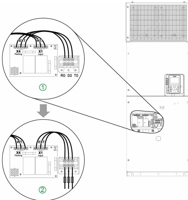
① 出厂接线：风机由 R/L1、S/L2、T/L3 在内部供电。
