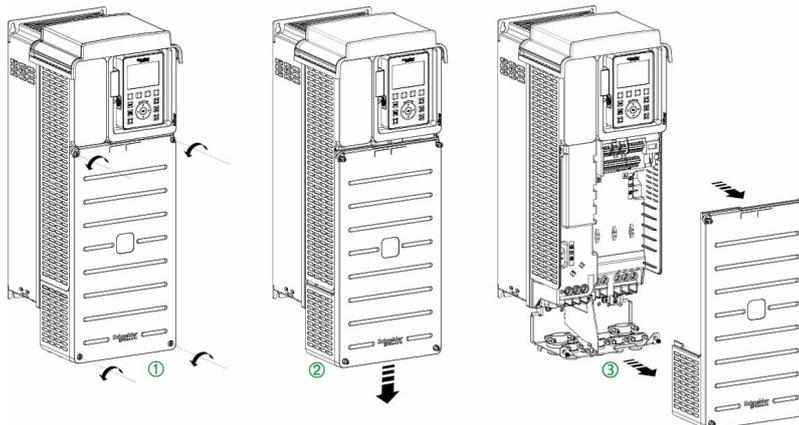
按照下列说明连接机架尺寸为 1 到 3 的变频器上的端子
