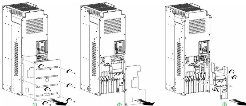
按照下列说明连接**机架尺寸为 6**的变频器上的端子
