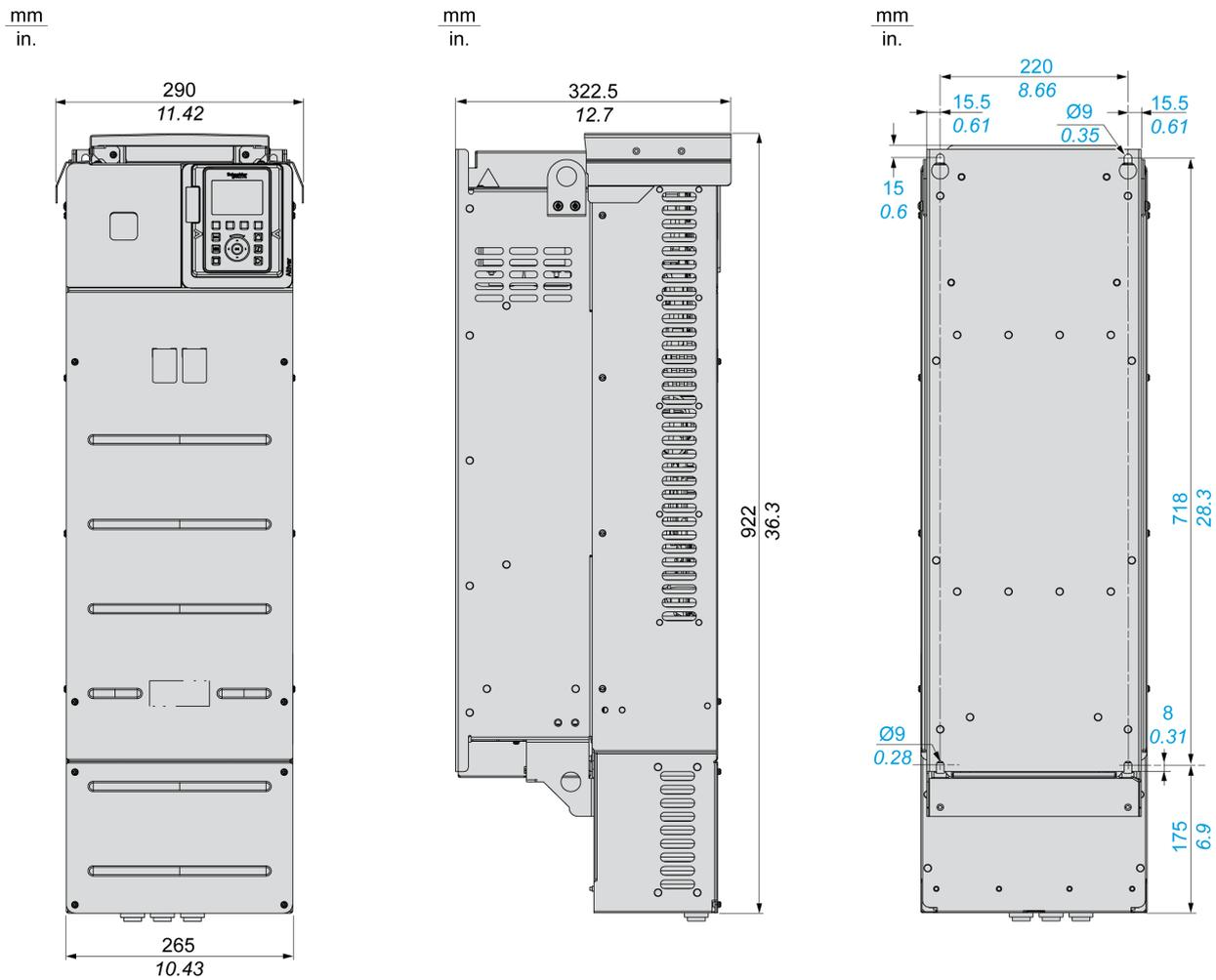
IP20 变频器，底部 (IP00) 除外 - 前视图、侧视图与后视图
