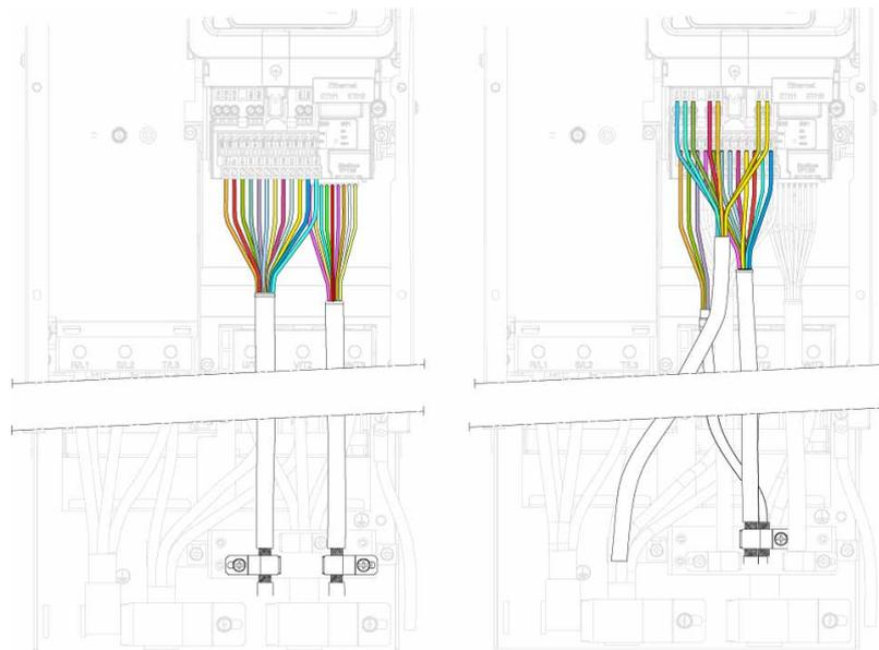
示例：用于 500-690 V 电源电压的机架规格 5Y 的电缆径迹
