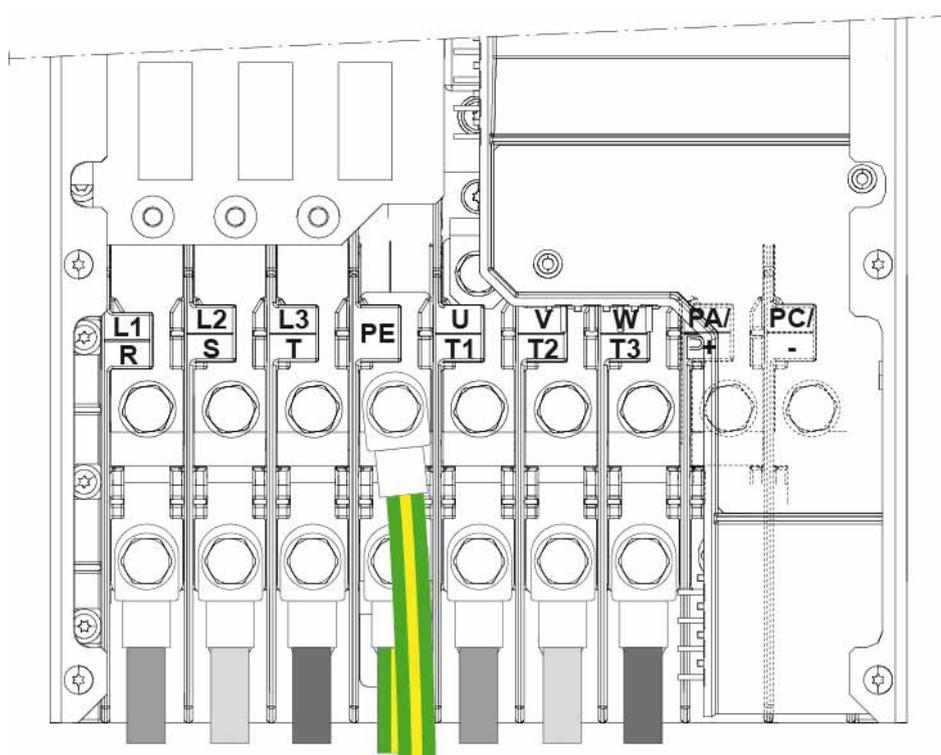
**注:** PA/+ 和 PC/- 端子用于连接制动电阻器。请参考制动电阻器说明书 NVE16635，可从 [www.se.com](http://www.se.com) 上获取。
