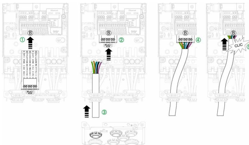
**注:** 图中所示的接线板适用于机架尺寸 2。其他接线板与此接线板稍有不同。
