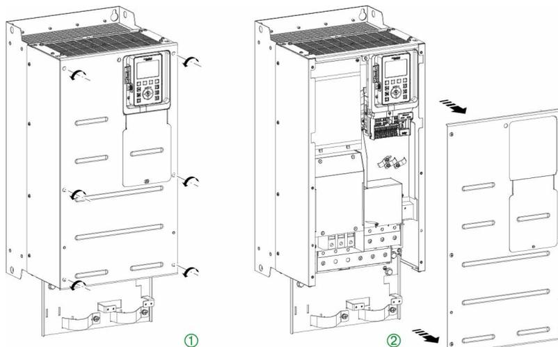
按照下列说明连接机架尺寸为 3Y 和 5Y 的变频器上的端子
