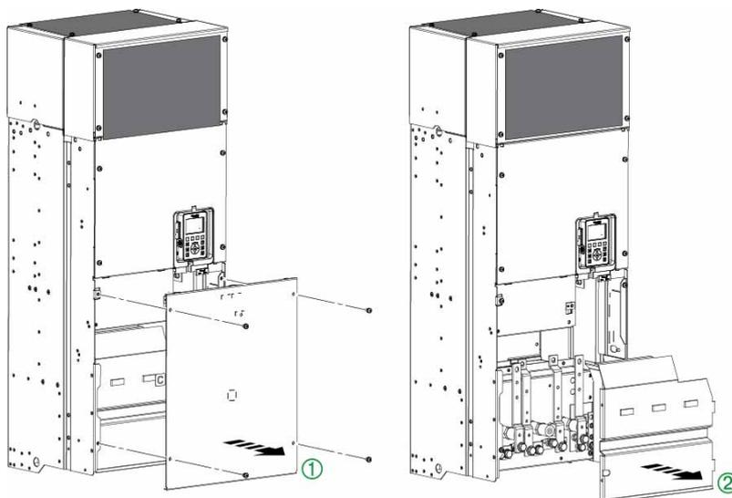
按照下列说明连接**机架尺寸为 7**的变频器上的端子
