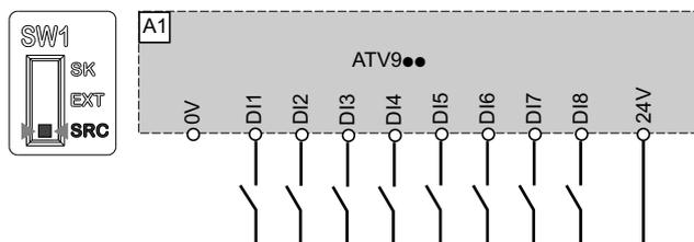
将开关设置到 SK (漏型) 位置
