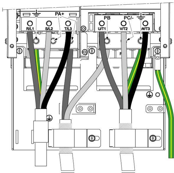
PA+ 和 PB 端子用于连接制动电阻器。请参考制动电阻器说明书 NHA87388，可从 [www.se.com](http://www.se.com) 上获取。
