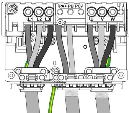
PA/+ 和 PB 端子用于连接制动电阻器。请参考制动电阻器说明书 NHA87388，可从 [www.se.com](http://www.se.com) 上获取。
