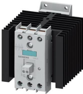
Halbleiterschütz 3-phasig 3RF2 AC 51 / 30 A / 40 °C 48-600 V / 230 V AC 3-Phasengesteuert Schraubanschluss Sperrspannung 1200 V
