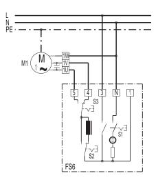
FS6 Stufenschalter S1 Schalter: Ein/Aus
