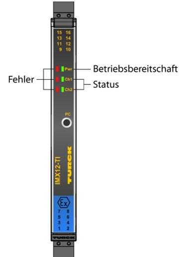
Der 2-kanalige Temperatur-Messverstärker IMX12-TI01-2RTDR-2I-C0/24VDC/CC verfügt über Eingänge für: RTDs nach IEC 60751, DIN 43760, GOST 6651-94 (2-, 3- und 4-Leiter) sowie Widerstände 0...5 kΩ (2-, 3- und 4-Leiter).
