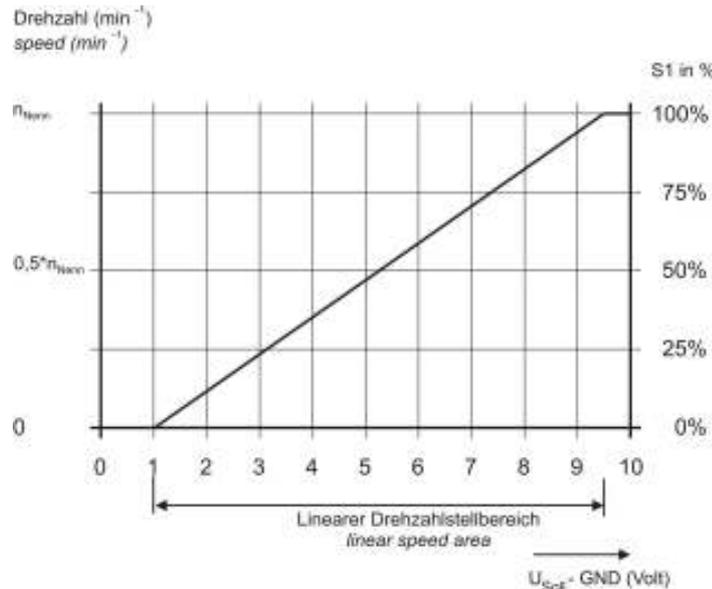
Der Drehzahlsollwert lässt sich durch ein angeschlossenes Potentiometer (S1 / 10 kΩ) von 0 bis 100% stufenlos einstellen. Kleinere Spannungssignale als 1 Volt werden von der Elektronik als Stoppsignal ausgewertet. Das Gleiche gilt für die Drehzahlstellung durch ein externes 0 – 10 Volt Signal.
