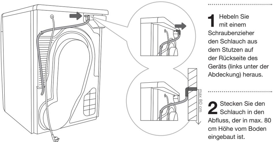
☼ Falls Sie den Schlauch für die Ableitung des Kondenswassers in einen Abfluss oder Ausguss einstecken, sorgen Sie dafür, dass der Schlauch gut befestigt ist. Damit wird ein eventuelles Ausfließen des Kondenswassers verhindert, was unerwartete Schäden verursachen könnte.
