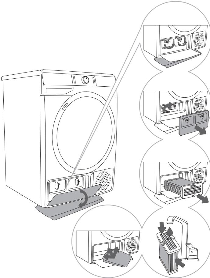
**1** Öffnen Sie den Außendeckel. Fassen Sie die Griffe am Innendeckel an und drehen Sie sie nach oben.
