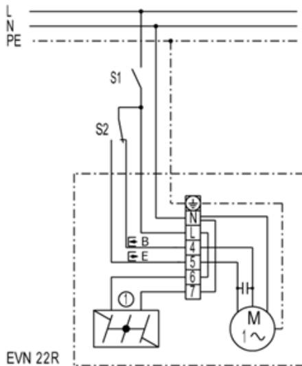
① Elektrische Verschlussklappe (außen)
