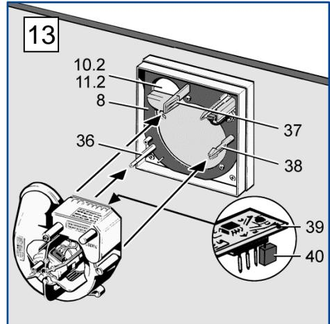
3. Lage der Gehäusebodendichtung überprüfen und diese falls erforderlich korrigieren.
