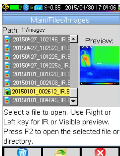
Der Dateimanager listet nur Infrarot-Bilder der Kamera auf, die mit einem Namen wie zum Beispiel jjjmmmtt\_hhmmssX\_IR.BMP generiert wurden, sowie die Ordner, um ein Verschieben im Navigationsbaum der SD-Karte zu ermöglichen.
