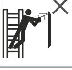
Nadmerné bočné zaťaženia nie sú prípustné, napr. pri vŕtaní do steny a betónu.
