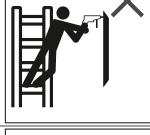
11. Les charges latérales disproportionnées ne sont pas autorisées, par exemple lorsque l'on perce dans des murs et dans le béton.
