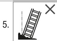
5. Placer l'échelle sur un support de niveau, horizontal et résistant. Les pieds de l'échelle ne doivent pas s'enfoncer dans la terre.
