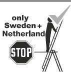
Alle treden/sporten boven het scharnierpunt van een trapladder met gemonteerde schuifladder mogen niet worden gebruikt om op te staan.
