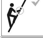
10. Pour monter sur l'échelle, en descendre et travailler sur l'échelle, bien s'agripper. Le cas échéant, prendre des précautions de sécurité complémentaires.
