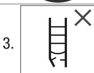
3. Žebřík po dodání a před každým použitím zkontolovat, zda není poškozený. Nepoužívat poškozený žebřík.
