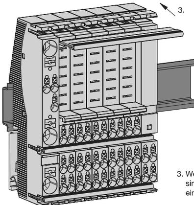
3. Wenn alle Module verrastet sind, Schienen positionsrichtig einstecken bis Anschlag
