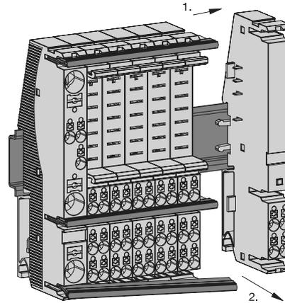
1. Zur Demontage der Schienen Signalisierungsmodul verschieben
