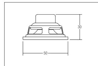
Lautsprecher-Einsatz Ø 50 mm für Einbauleuchten, weiß, rund. Ausgeführt in kompakter Bauform für werkzeuglose Schnellmontage zum Deckeneinbau. Nenn- / Musikbelastbarkeit: 3 / 4 W, Impedanz: 20 Ohm
