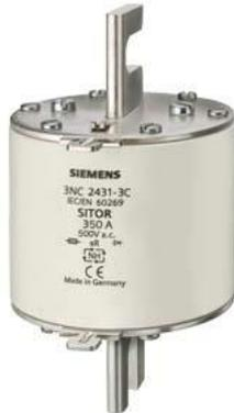
SITOR-Sicherungseinsatz, mit geschlitzten Messerkontakten, NH3, In: 350 A, gR, Un AC: 690 V, Un DC: 440 V, Stirnkennmelder
