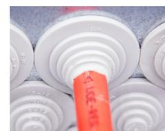
Abb. 2: Stufennippel mit Schutzart IP55 am Kabeleingang
