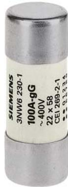
SENTRON, Zylindersicherungseinsatz, 22x58 mm, 100 A, gG, Un AC: 500 V
