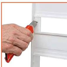
Die Geräteeinheiten können durch Ausbrechen der Vorprägungen von 12 auf 14 TE verbreitet werden
